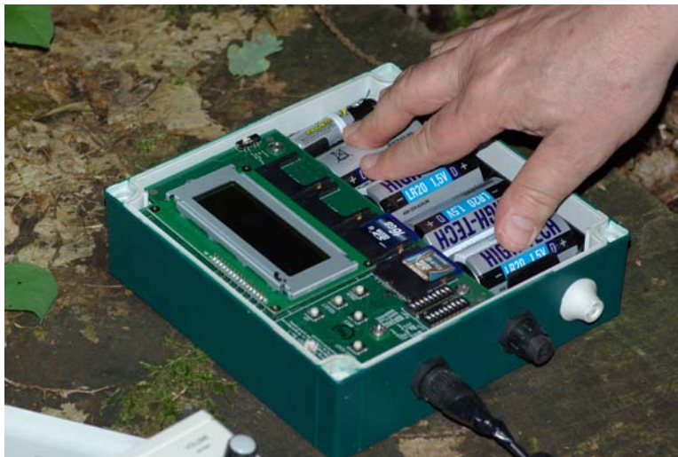
Photo 8 : enregistreur Song Meter SM2BAT (Wildlife Acoustics Ltd.) (P. Gourdain)
